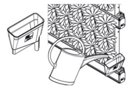
\* Leichtes Befüllen des LivePanel Systems durch den mitgelieferten Trichter
